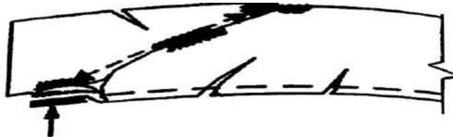
Fig. 4.9 : Arch rib failure
