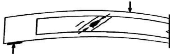
Fig. 4.8 : Web crushing failure
